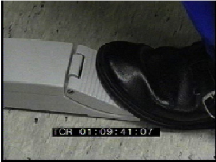
Abbildung 6: Ein Fusschalter dient zur elektronischen Regelung der Pumpe
